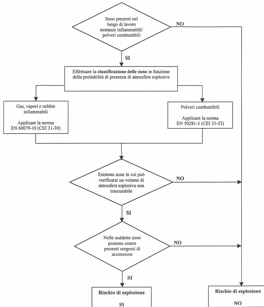
I luoghi con pericolo di esplosione devono essere suddivisi in zone, in funzione della probabilità di presenza di atmosfere esplosive.
